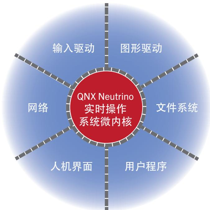
独特的QNX微内核实时操作系统架构可以防止一个零部件的故障对其他程序或内核产生破坏作用这种情况的发生。该实时操作系统可以自动进入安全状态，或重启任一故障零部件。
